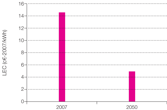
Figura 714. Coste específico normalizado de la generación de electricidad en el mix-3b2 dimensionado para cubrir la demanda de electricidad directa (incluye EVs) del contexto E3.0 en el año 2050. SM = 1,55 ; SF_{el\acute{e}ctrica} = 97,2\% ; SF_{tot} = 57,6\% ; F_{disipada} = 15,3\% ; C = 3 TWh; CF_{global} = 31,5\% ; A_{territorio} = 3,3\% .
