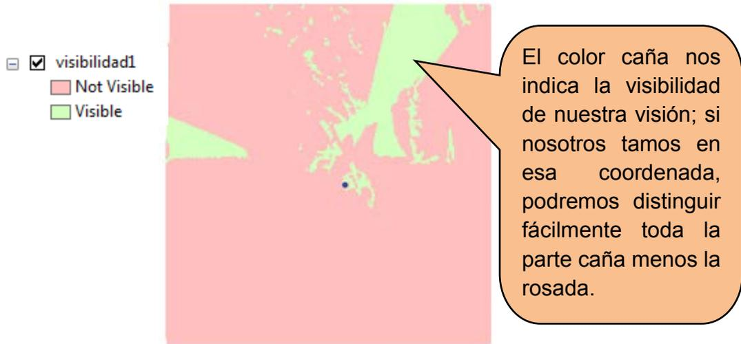
En la figura se muestra un mapa visibilidad construido a partir de un mapa de luminosidad de elevaciones y un punto de observación.
