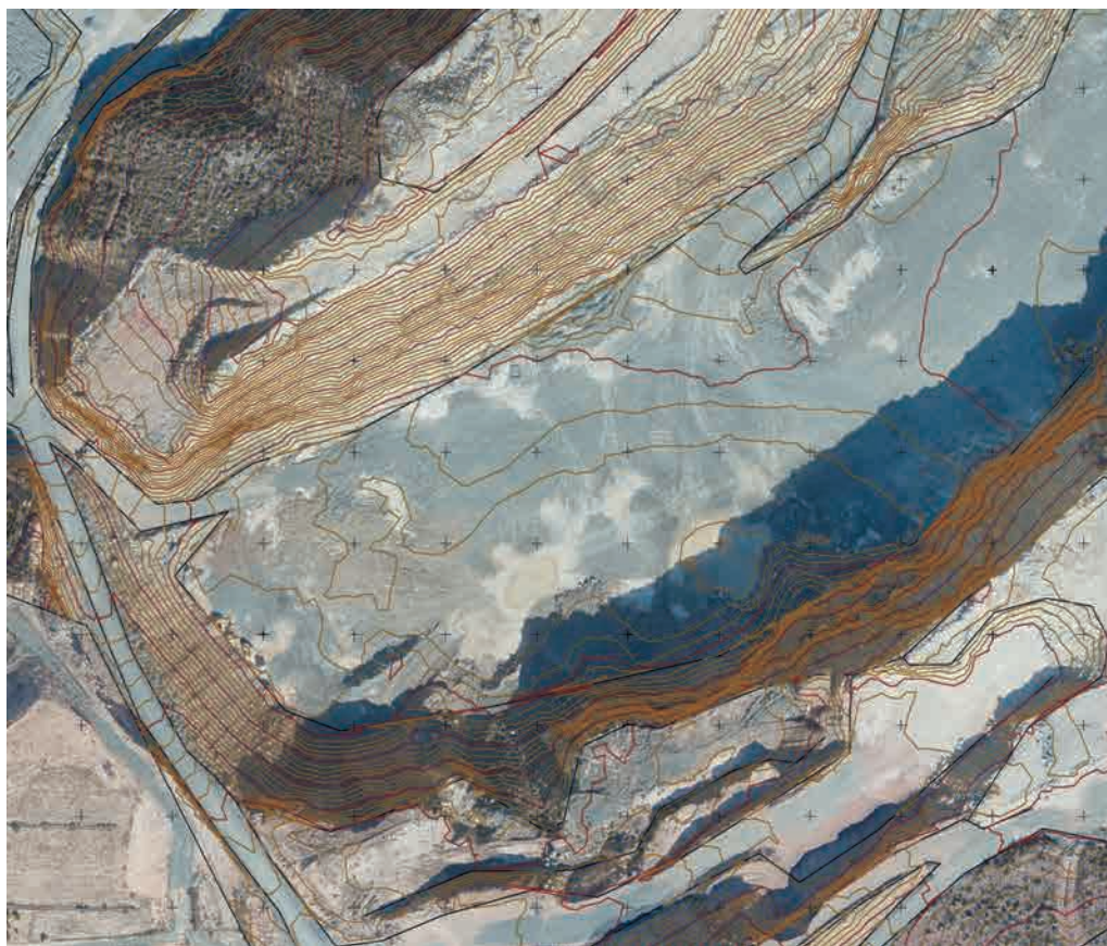
Figura 5.3. Composición cartográfica por capas 3D (ortoimagen, curvas de nivel y DTM a diferentes alturas) (Fuente: UAV Blackbird S.L.).
