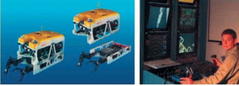
Figura 7.2. ROV, unidad básica, modulo brazo robótico y estación de operador.
