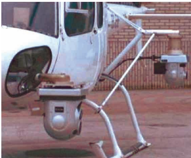
Figura 20.1. Helicóptero con el equipo de filmación montado.
