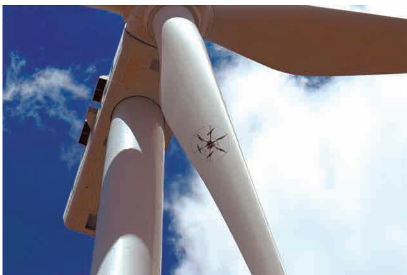
Figura 19.2. La posibilidad de aproximarse a distancias muy cortas a la pala sin que los riesgos de colisión supongan un problema es un aspecto esencial de la inspección eólica.
