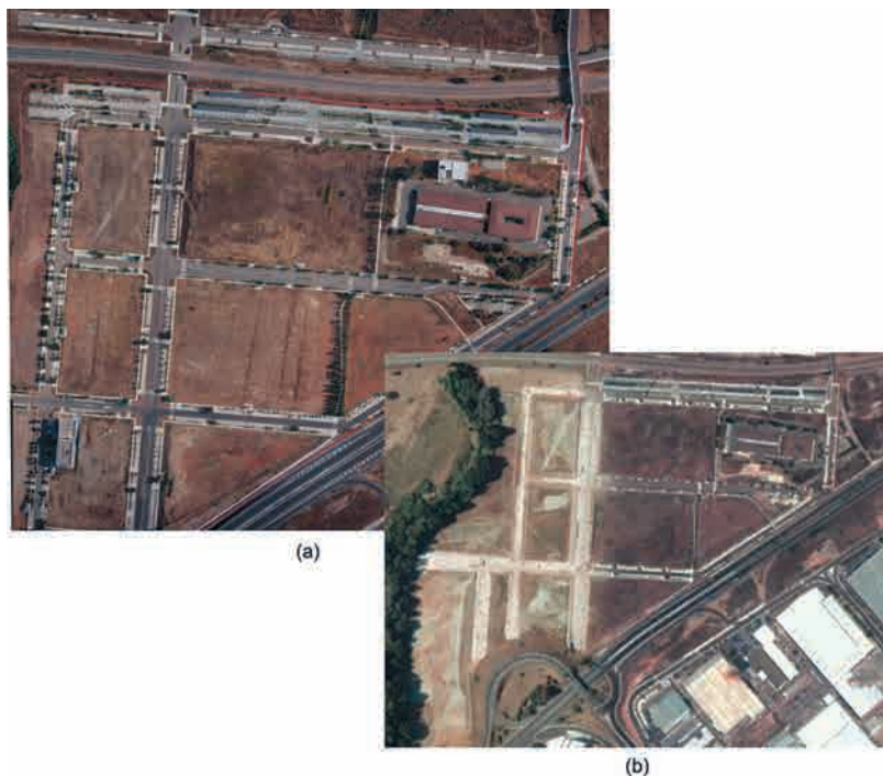
Figura 18.2. Comparativa temporal productos cartográficos: (a) mediante el empleo de plataformas UAV y (b) plataformas convencionales (Ortofotografía UAV producida por Aerometric Lab, Universidad de Córdoba).
