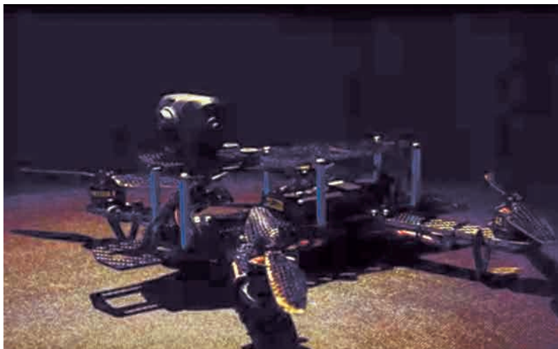
Figura 17.6. Modelo de dron TBS: equipo de alta velocidad que permite un vuelo superior a los 100 kms /h. Algunos pilotos de Drones Rescue Spain son capaces de pilotar este modelo entre olivares en visión FPV ( First Person View , visión desde la cabina).
