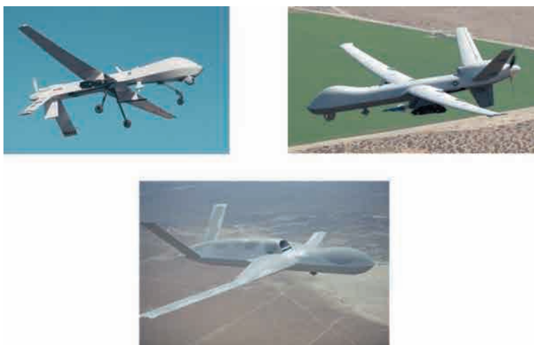
Figura 1.10. Evolución seguida por los diferentes modelos del UAS Predator . De izquierda a derecha y de arriba abajo, modelos A, B y C.
