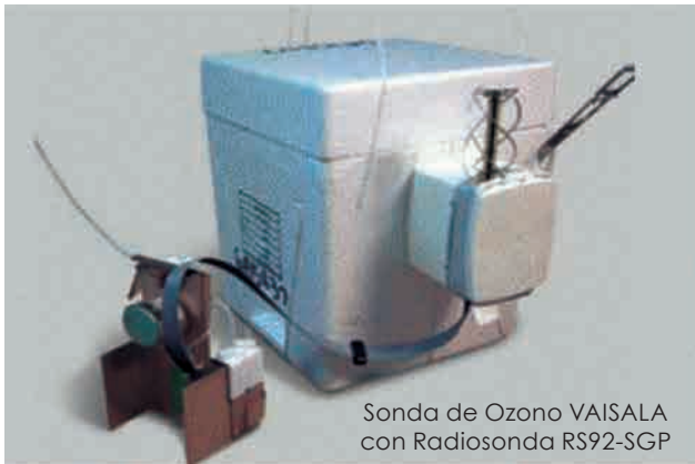
Figura 4.1. Imagen de los dos tipos de sensores más usados para realizar el control de calidad atmosférica. A la izquierda una sonda electroquímica de medida del ozono y a la derecha un medidor en el ultravioleta.
